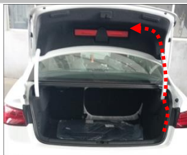
3.2 把 2 扎布线束（接开关、接门锁信号）从右装饰板位沿着后门胶条把线引到上门锁处；
