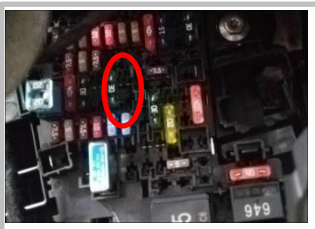
3.9 接正极线：此原车 30A 旁预留空位
