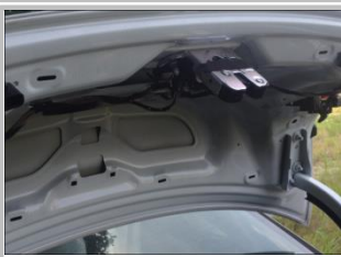
4.5 上尾门板复原安装
