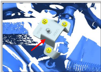
2.10 如图示意安装上支架、上支架夹紧板
