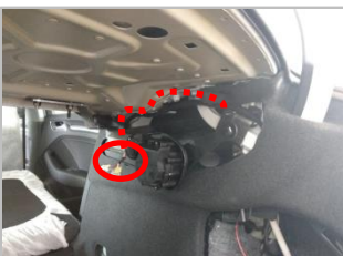
3.17 电机线走线，并预留足够长度，圆圈位置用扎带固定好电机线
