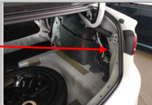
4.3 安装蜂鸣器：并把蜂鸣器装在左侧装饰板内空旷处；（ECU 附近）
