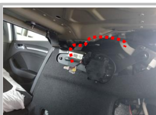
3.18 绕过摆臂后贴近钣金至 ECU 位置
