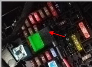
3.12 接正极线 同角度放大示意图，请认准孔位安装
