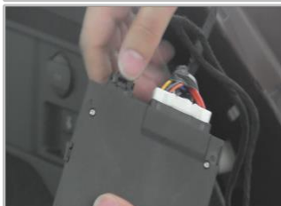
3.19 连接 ECU，将所有各部位线束插头连接好，最后把主线束插头对应安装到 ECU 上，先黑后白的顺序接上
