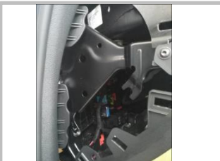
3.8 接正极线：拆开原车装饰板，看到原车保险盒；
