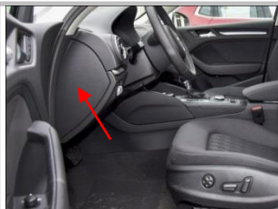
3.7 接正极线 拆开驾驶室左中控台装饰板；
