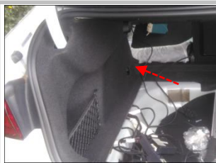
3.4 布正极线 将连接正极的线如图所示，通过尾箱后，
