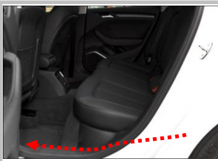
3.5 布正极线：把左 C 柱及迎宾踏板掀开，把正极线穿出（虚线）；同时把橙色解码器控制线从驾驶室反向延伸至上尾门处；
