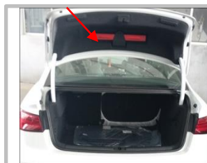
3.1 拆下原车上门盖板；
