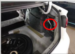
3.13 接负极：在尾箱右侧内此处找到原车螺栓柱
