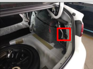
3.20 使用魔术贴将 ECU 固定在此空旷处（方框）防止松动脱落、异响；
