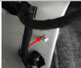
2.5 如图示意 T 型螺栓-M6 已安装好
