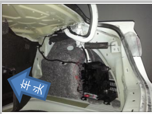
2.2 如图示意，右装饰件已拆下
