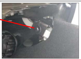
2.15 驱动盒装在上支架固定头内，确保卡紧到位
