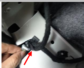
2.4 T 型螺栓从后面塞进去，可以在 T 型螺栓-M6 把柄缠一点胶布加长，即容易塞进去
