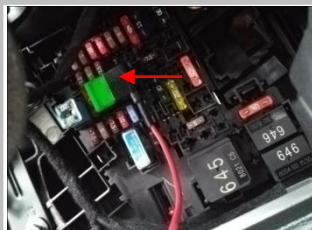
3.11 接正极线：保险丝取电器复原插上，注意取电器插头带铜芯一头正确插入所指原车带铜芯一头取电；
