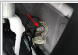
3.14 接负极：松开原车螺栓不用拆下，负极铜片卡在螺栓上，再把螺母拧紧；
