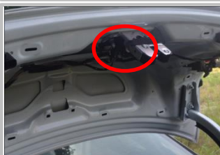
3.15 接尾门信号线：在上尾门门锁背后找到原车信号线插头
