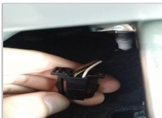
3.16 接尾门信号线：用我们配的转接线连接，再把我司转接线插头（箭头）插进上门锁；转接线引出的蓝色线、棕色线对应我司配的蓝色线、棕色线；
