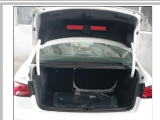
4.6 把拆下的装饰件还原安装回去；检查安装的螺钉是否全部锁紧，检查所有拆卸的装饰件是否全部锁紧，安装完成；
